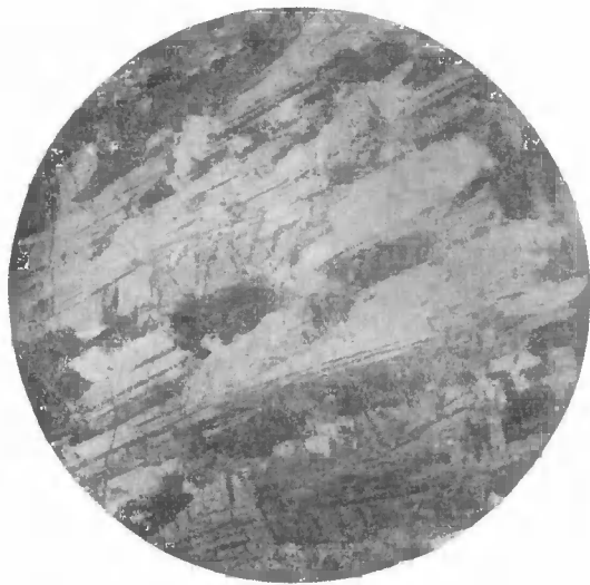
Рис. 3. Шлиф шара под микроскопом. Светлый минерал — плагиоклаз
